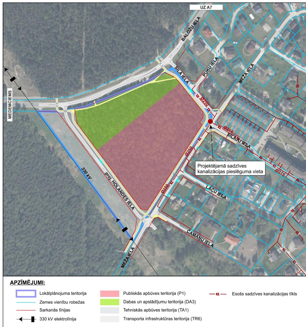
15.attēls. Sadzīves notekūdeņu kanalizācijas shēma
