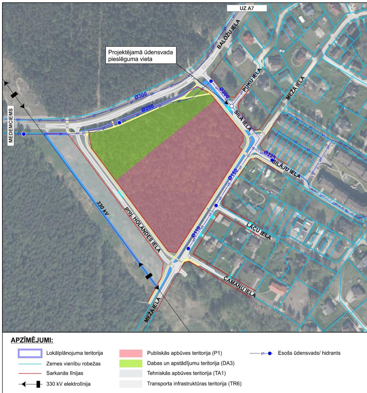
14.attēls. Ūdensapgādes shēma
